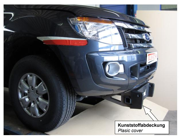
Hier sehen sie den fertig montierten Schneepflugabstützsatz. Bevor sie mit der Montage beginnen, lesen sie bitte diese Anleitung und die Bedienungsanleitung des Schneepfluges gut durch. <u>Achtung:</u>
